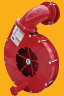
Toutes les turbines Jamesway sont faites d'acier T-1 pour assurer leur durabilité, et leur construction modulaire entièrement boulonnée rend l'entretien facile, rapide et économique. L'option de turbine et boîtier en Hardox 450<sup>MC</sup> offre un summum de durabilité avec le sable ou avec d'autres matériaux hautement abrasifs.
