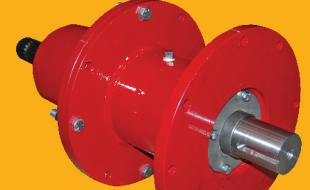
C'est dans le bain d'huile que s'effectue le mariage entre robustesse et grande précision. Les paliers de l'arbre de turbine de 2 pouces se trouvent dans un bain d'huile protégé par le système de joints étanches exclusif de Jamesway, alors que le graisseur et le réservoir d'huile assurent une lubrification constante et une longue durée de vie.
